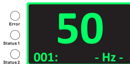
Obr. 23: Displej během komunikace přes infračervené rozhraní
